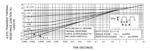
Fig. 3-TYPICAL THERMAL RESPONSE
