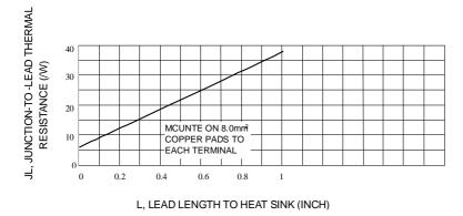
Fig. 4-TYPICAL THERMAL RESISTANCE
